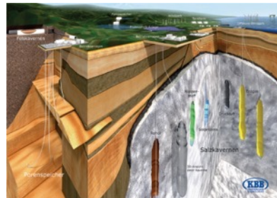
Speicher ein stieg
